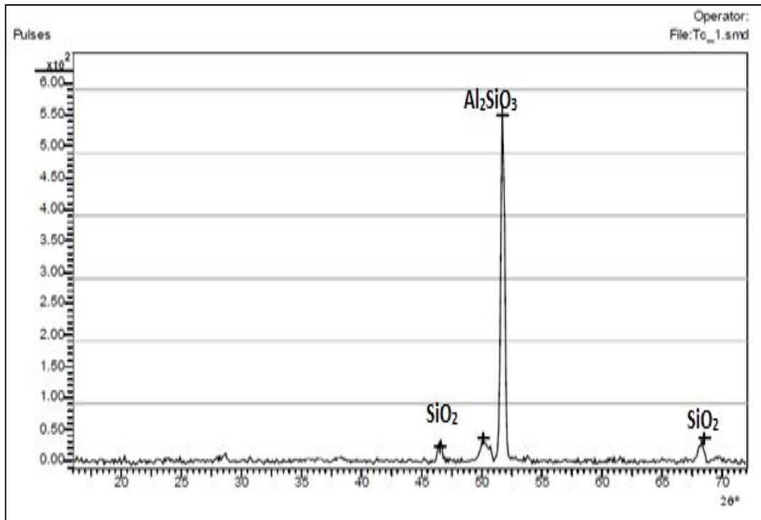
Plate 3 : XRD spectrum for Feldspar
